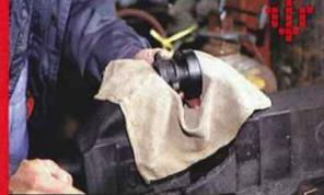
サポートプッシュに新しいスラストベアリングを圧入する。この作業は新しいベアリングをサポートプッシュの上にかぶせて圧入するだけの作業なので、このように普通の方で作業することが出来る。誤ってベアリング本体やサポートプッシュに傷つけることがないように、ウェス等で保護しておこう。
