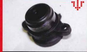
これがベアリングを取り外した状態のサポートプッシュ。この先端にリング状のスラストベアリングが圧入されているのだ。横に出ているミミの部分は、プリロードスプリングが取り付けられている場所。このパーツは現在欠品中ということなので、作業時に壊してしまわないように注意しよう。
