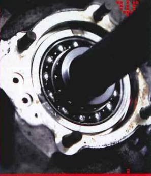
サポートフランジを取り付けたら、次はスラストベアリング+サポートプッシュ、プリロードスプリングを取り付ける。これらのパーツが外れないように三角形のロックプレートを取り付けられており、フランジの上部に2本のボルトで固定されている。スプリングは念のため新品に交換した。
