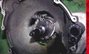
ベルハウジングの中央に取り付けられている部品が先月取り外したプッシュサポートフランジ。写真では少し分かり難いかもしれないが、段差の部分に設けられた二つの穴がクラッチのための油圧の経路となっている。確かにリリースフォークでベアリングを押すよりも合理的な構造のように思える。
