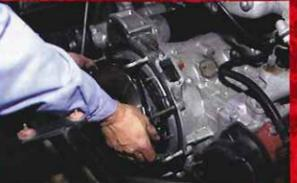
まず最初に、汎用品のクラッチ・アライメント・ツールの中から適当な太さのシャフトを捜し出し、クラッチシャフトの代わりに差し込んでおく。次に前側の、つまりダンパースプリングが付いている方のクラッチディスクを取り付ける。もちろん取り付けとは違って差し込むだけの作業にすぎない。
