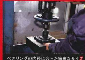
ベアリングの内径に合った適当なサイズのカラーを探し出し、プレスを使ってサポートプッシュの部分だけに圧力を掛けて押し込ませる。別に専用のカラーでなくても、外径が同じソケットレンチのソケットなどを流用することもできる。このようにプレスを使用すれば、ベアリングはあっけなく外れる。
