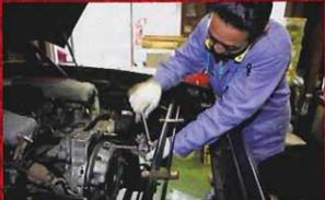
SSTがあるのかもしれないが、今回は本物のクラッチシャフトをアライメント・ツール代わりに使った。まずクラッチシャフトをベルハウジングごと差し込み、ハウジング周囲の切り欠き部分からレンチを差し込みクラッチカバーを仮締めする。次にベルハウジングを外してから、カバーを本締めする。
