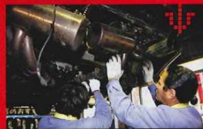
取り外すときにあれだけこずったはずのマフラーだったが、取り付け作業はあんなに簡単で終わった。慎重に壊さないで外すようにしたので、取り付け用のボルト&ナット類もそのまま再使用することができた。左右が逆になっていたセンサーも正常な状態に戻しておくことにしよう。
