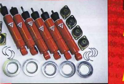
減衰力の調節が終わったら、分解したとき逆の手順で装着する。右ページ上の写真にあるアルミのリングはスプリングを受けるための座金。左右に置いてある半円形のバーツは、ショックのケースに取り付けて、ちょうどバルブのコッターの様にして座金を支えている。両者共にショックのバーツの中に含まれており、フェラーリのバーツリストには掲載されていない。分解したサスペンションのアームを持ってみたら、意外なほど軽かったのが、さすがにショックやスプリングを組みつけた状態ではそれなりの重さになる。このようにジャッキで下から支えながら、二人がかりで作業となる。
