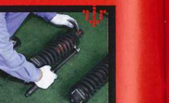
フロントが終わったら、次はリアの作業に入る。テスタロッサのリアサスペンションはツインのショック＆スプリングを採用しているので、その分作業の時間も掛かってしまう。もちろんショックもスプリングもフロント用とは別バーツで、マニュアルでは線径φ15mm、自由長317.9mmになっている。
