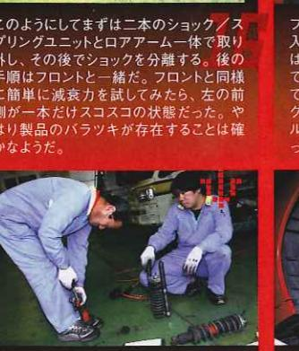
次は取り外したショックアブソーバー／スプリングのユニットを分解し、ショックアブソーバーのみを取り外す作業に入る。コイルスプリングを使用しているクルマのサスペンションを分解するには、この写真のようなスプリングコンフレッサーといつ工具が必要になってくる。いくつかのタイプがあるが、チューンナップセンターでは、このようにオーソドックスな両側から挟み込むタイプを使用していた。コンプレッサーの中には構造上スプリングが外れやすかったり、素材自体が悪くて破損してしまう様な粗悪品まで出回っている。この作業は危険(死亡例もある)なので、もし購入するときには値段だけではなく安全な物を選ぶこと。
