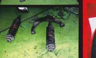
このようにしてまずは二本のショック／スプリングユニットとロアアーム一体で取り外し、その後でショックを分離する。後の手順はフロントと一緒に。フロントと同様に簡単に減衰力を試してみたら、左の前側が一本だけスコスコの状態だった。やはり製品のバラツキが存在することは確かなる。
