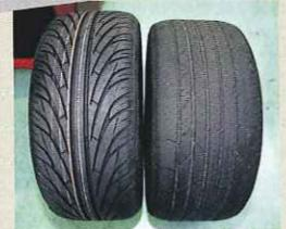
イヤのように見えるかもしれないが、実は両方とも同じサイズ。磨耗と変形でこのような差が出てしまうのだ。
