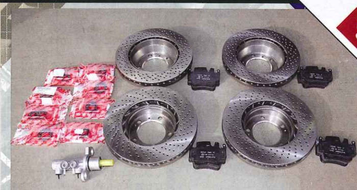
今回用意した新品パーツ。前後ディスク、パッド、マスターシリンダー、キャリパーのO/Hキット。この写真の通り、通常このタイプの996は前後で同じパッドを使用する。しかし、実は最初期モデルだけリアのパッドが異なることが判明。急遽ディーラーで調達することにした。
