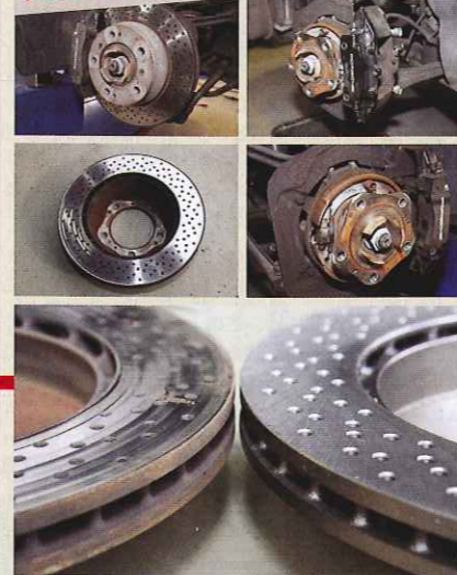
今回用意した新品パーツ。前後ディスク、パッド、マスターシリンダー、キャリパーのO/Hキット。この写真の通り、通常このタイプの996は前後で同じパッドを使用する。しかし、実は最初期モデルだけリアのパッドが異なることが判明。急遽ディーラーで調達することにした。
