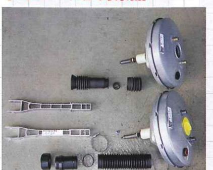
上が今回取り外したバーツで、下が新しく入手した対策バーツ。アルミ押し出し材の棒状の部品がペダルとマスターをつなぐブレーキブッシュロッド。下の対策部品ではペローズと接続ビースでこのブッシュロッドの部分を完全にシールドする構造になった。
