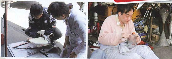
せっかくアクリルで三角窓用も用意したので、交換することになりました。後から差し込んでシールで止めているだけなのに、作業してみたら外すのは結構大変。さらにアクリルのウィンドウを差し込むのは無茶苦茶大変。でも、アクリル仕様とガラス仕様を手持って比べてみたらその差は歴然でした。
