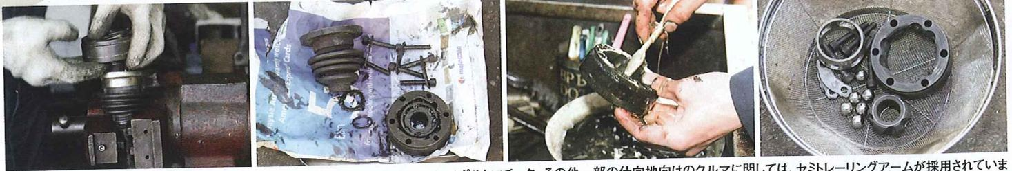
普通の空冷ビートルのリアサスペンションはスイングアスルですが、1302、1303、スポーツマチック、その他一部の仕向地向けのクルマに関しては、セミトレーリングアームが採用されています。セミトレの場合、ドライブシャフトは2か所にCVジョイントを持つタイプとなるので、ワーゲン乗り達の間では“セミレ”じゃなくて“ダブルジョイント”と呼ばれるのが普通です。CVジョイントはこのように分解式になっていて、OHすることができるようになってます。バラして、洗浄して、新しいグリスを詰めて、ブーツを交換すれば完成。
