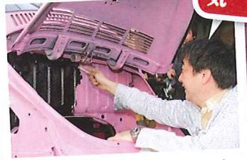
作業当日、BISに到着したら、すでにミッションが載ってました。2Lオーバーのパワフルなエンジンなので、トルクで捨れないようにジーンバーグのミッション・マウントを追加してあります。ラゲッジルームとエンジンルーム内は、ブラックにペイントすることにしました。ワイルドな雰囲気を出したかったので、あえて刷毛塗りを選択(ウソ)。
