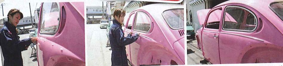
古いビートルだったらモールレスの仕様も渋くて良いけれど、さすがに1303みたいな高年式? のビートルでモールが無いというのはちょっと変。そこで、ステンレスのモールを使用することになりました。モールはボディの穴に樹脂製のクリップを差し込み、それにはめ込むことで装着されています。このクリップは経年変化で劣化するので新品に交換です。
