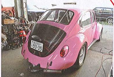
最後の仕上げはリアフードの取り付け。このFRP製フードには、冷却用スリット等はまったくありません。そのまま完全に閉じてしまうと、エンジンルーム内の温度が上がって色々な不具合が生じる可能性があります。しかし、草レース用のクルマであるビンピーの場合、フード上側が少し開いた状態にしてあるので、渋滞時はそこから熱が上に逃げますし、走行時にはフレッシュエアが大量に入ります。でも雨は苦手だなあ。
