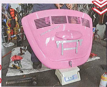
ビンピーにFRP製のリアフードを装着する理由は軽量化。まあこの写真通り、実際の軽量化というより、視覚的=気持ちの上での軽量化効果の方が
