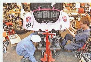
引き続いてノーマルエンジンを載せる作業を開始します。先月号でも書いた通り、このノーマルエンジンもクラッチディスクは新品に交換しましたし、発電機をダイナモからピンピのオルタネータに交換してあります。
