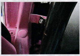
このポロのインパネはご覧のように何箇所かのボルトで固定されています。表面にバコッと上から被せるようにして装着されているため、ボルトとハーネスを取り外すだけで、比較的簡単に取り外すことができるようになっています。
