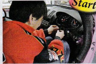
最初の作業はステアリングの取り外し。ステアリングを外すときには、センターのナットを完全に外してしまわないこと。そうしないと、ステアリングが固着していたりした場合、抜くときに顔面にヒットして怪我をする恐れがあります。
