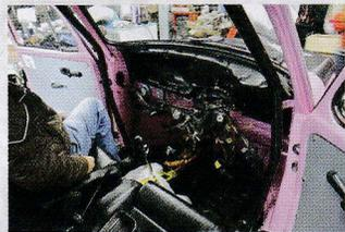
これがダッシュボードを外した状態。同じ空冷VWでも1302まではフラットなインパネでしたが、1303のみは樹脂製のダッシュボードを上から被せてあります。そのためダッシュを取り外した状態ではこのような状態になってしまいます。
