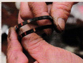
組み込む前に外したパーツとこれから組むパーツの直径や幅が同一かどうか確認します。下がもともと付いていたシール、上が新品。
