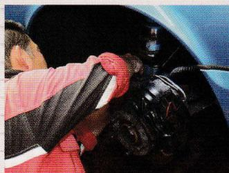
パッドの残量を知らせるセンサーも組み込みます。
