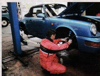
4輪ともキャリパーを装着したらエア抜きをして完成。もうひとりのメカニックがペダルを踏み、大橋さんがブリーダープラグを緩め、閉めを繰り返します。
