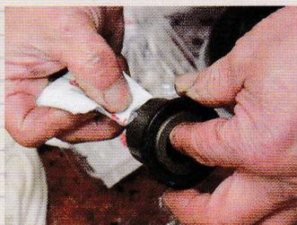
新品のピストンに新品のブーツを組み込み、同梱されていたグリスをピストンの周囲に塗ります。
