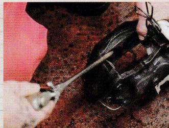
エアで水を吹き飛ばし、完全に乾燥させます。さらにブレーキクリーナーを使って脱脂します。
