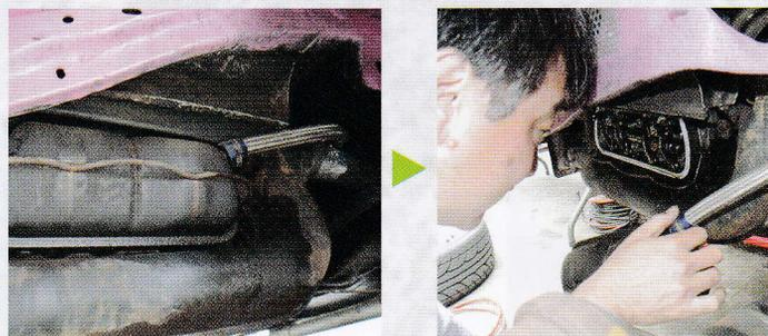
古Q編集長が右側からオイルが漏れているというので確かめてみたら、案の定、タベットカバーのバックギンからのオイル漏れでした。このバックギン、ご覧のようにコルクで作られているので、交換するのが簡単である反面、あまり耐久性は高くありません。消耗品として、にじんできたらこまめに交換するしかありませんね。タベットカバーは弁当箱みたいなプレス成形のパーツで、ごつい針金みたいなストッパーで固定されているだけ。ドライバーでこじれば簡単に外れます。取り付け時にバックギンがずれることがあるので、脱脂してG7みたいなボンドで止めておくという方法もあります。カバーの横のホースはレース用に追加した部品で、オイルキャッチタンクにつながっています。
