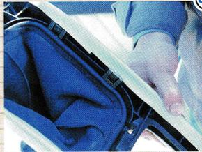
これはコンソールの内側、シフトレバーのブーツが取り付けられている部分です。このように片側2箇所がクリップで固定されていました。レバー自体はシフトレバーに押し込んで固定するだけ。この部分の質感もイマイチかな。
