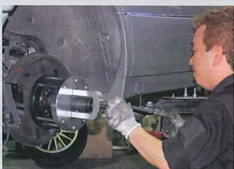
グリスアップだけなら車上でも可能だが、完全にドライブシャフトをハブから抜くにはSSTが必要となるので、整備となる。
