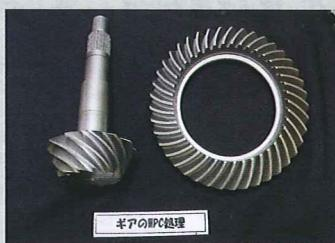
ヘアライン号も処理したデフ、ギアのWPC処理。トランクにはスペアタイヤがあるため、空気抜けが悪く高温になる500Eのデフには有効。
