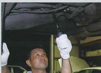
片側、デフ部の6本のトリプルスクエアのボルトを緩めるのは結構大変な作業。ボルトは再使用不可なため新品を用意する。
