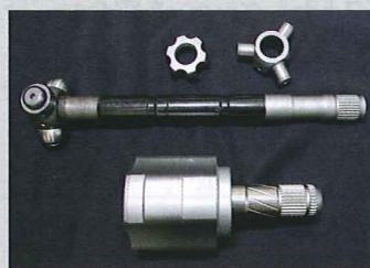
ドライブシャフトのWPC処理はまずバラバラに分解し、スプライン部、CVジョイントのボールなどに施し、強度と潤滑を確保。
