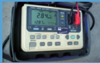
バッテリー内部の抵抗値が2オーム台で、一般のバッテリーと比べて少ないのが特長。瞬発力にも富む。
