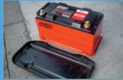
他のディープサイクルバッテリーとは異なり、無加工で純正固定金具を使える専用ステーが備わっている。
