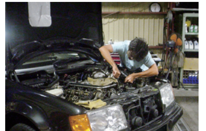
SPEED JAPAN 北村号は、弱点のチェーンテンショナーとアッパー部分のガイド、ガタの出るオイルデリバリーチューブを対策品に交換し、予防整備は万全だ。
