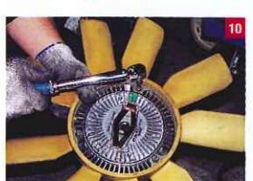
カップリングとファンブレードは、3本のネジで固定されているだけ。コレを外して交換して、後は逆手順で組み付ければOKだ。
