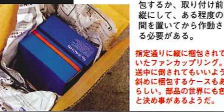
その形状ゆえ、ついベアリングと平置きしてしまうくなるファンカップリング。しかし、これは継ぎ置きで保管することが指定されている。立てた状態で取り付けられる部品なので、ある意味納得だが……。これを知らないバーツショップもある。輸送時にも縦にして梱包するか、取り付け前に縦にして、ある程度の時間を置いてから動作させる必要がある。
