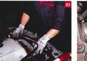
ラジエーター側とファン回りのシラウドが完全に分離したら、ファン側を押さえながらラジエーター側を上方向に抜き取る。
