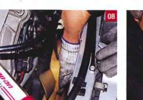
中央部分のロックボルトが緩んだら、これを完全に取り外せばカップリングが外れる。緩めてしまえば簡単。簡単そうで難しい作業だ。
