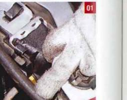
交換作業は、ファンシラウドをバラすことから始める。シラウドをラジエーターに固定している、左右合計2つのクリップを取り外す。
