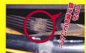
表側が非常にキレイだったのでつい油断していたのですが、外したベルトはリブ部分があみだクジができるぐらい横方向のヒビだらけ。それにしても抜け落ちるとはね。
