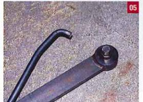
これがファンカップリングを外すための専用工具。使い方は次の写真で。ソケットタイプの純正工具では、ラジエーターに当たってしまう不便とか。
