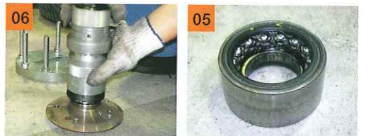
06 外したフランジに残るベアリングの一部を、SSTを使って抜き取る。これもないと難しい作業。 05 取り外したホイールベアリング。この小さなボールで、車体を支えていることになる。
