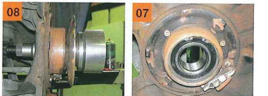
08 最後にベアリングにフランジを圧入しているところ。ブレーキ回りとタイヤを取り付けて完了。 07 04工程の逆の手順で圧入された新品のベアリング。ここでもSSTが活躍する。
