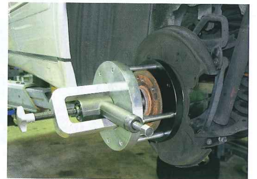
ハブキャリアを外さずにフランジ部分を抜き取るためのツール。見た目には「こまめでやらずに……」と思うほどにゴツイ。
