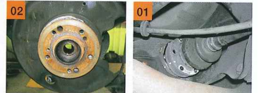
02 Cクリップで固定されているハブ側を抜き取った状態。このフランジを上側のツールで抜き取る。 01 まずはドライブシャフトを外す。このようにボルトで固定されているデフ側を先に外す。
