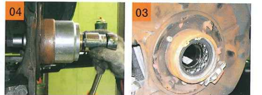
04 ベアリングの抜き取りに使用するツール。ハブキャリアに当てて、少しずつ引っ張り出す。 03 フランジを外すと、中にあるベアリングがこのような一部割れてしまう。必ず交換が必要だ。
