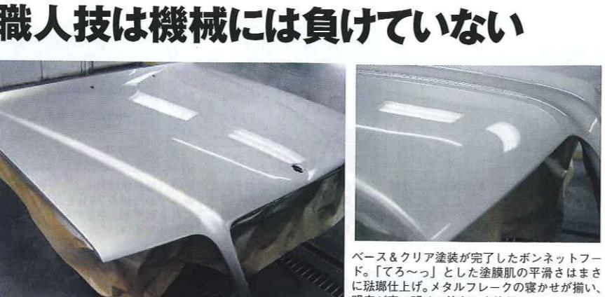
ベース&クリア塗装が完了したボンネットフード。「てろーっ」とした塗膜肌の平滑さはまさに琺瑯仕上げ。メタルフレークの寝かせが揃い、明度が高い明るい塗色にも注目。
