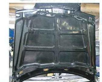
一枚ものの炭素繊維クロスで作った CFRP ボンネット。フェンダーとの隙間、チリ、表面の平滑度へのこだわりは板金屋ならではの高水準。
