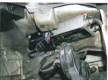
イグナイターと同時点灯キットはフェンダー内に設置。高温になるエンジンルーム内の設置はできれば避けたいところ。
