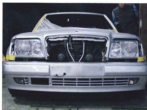
補強用の追加の裏骨の形状がよく分かる。前のボンネットキャッチは純正を利用。ジュラルミンサンドイッチ補強で強度も十分。
