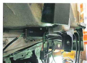
移設したホーンは右側に纏めて設置。取り付けには手間がかかるが、HIDユニットもここならノイズや熱、水濡れの影響がなく安心。
