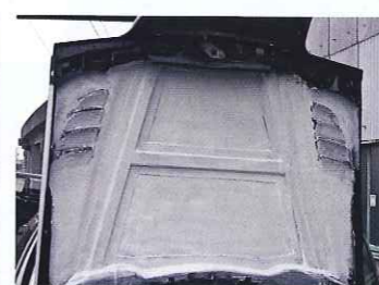
補強用の追加の裏骨の形状がよく分かる。前のボンネットキャッチは純正を利用。ジュラルミンサンドイッチ補強で強度も十分。
