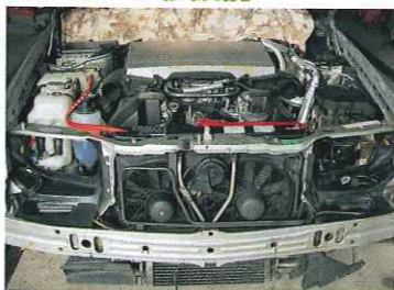
こちらがホーン移設前の写真。グリル内のステー中央部にホーンが配置されているため、冷却風がスポイルされるのは否めない。
