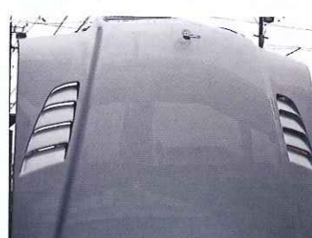
エンジンルーム内に落とし込まれた左右のダクトの形状がよく分かるショット。熱だまりの左右バルクヘッドから強制排気が可能。
