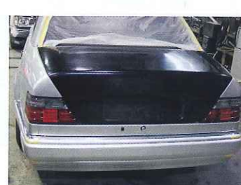
トランクは後期用の形状で、FRPの2プライム裏骨。粗悪品のFRPトランクとは一線を画したベンツの車格に合う一流品。
