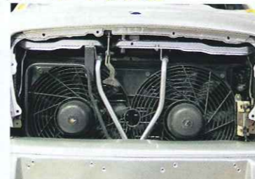
ホーンを右バンパー内に移動し、残ったブラケットはカットして塗装。冷却効果も僅かだが上がり、すっきりした印象に！
