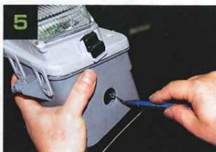
5 HID のブラストからパーナーへの高圧側配線を通すため、フォグランプ下側にある純正の配線穴を加工する。ゴム製のグロメットが入るように穴径を拡大する必要がある。
