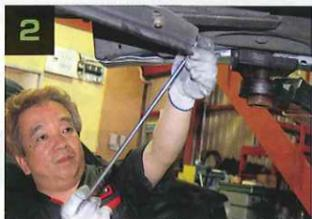
2 ホイールを外して、まずはアンダーカバー、フェンダーライナーを外す。ライナーは、片側5個のナットと6個のボルトで固定されているメンパー前の隠れたネジが外しづらい。
