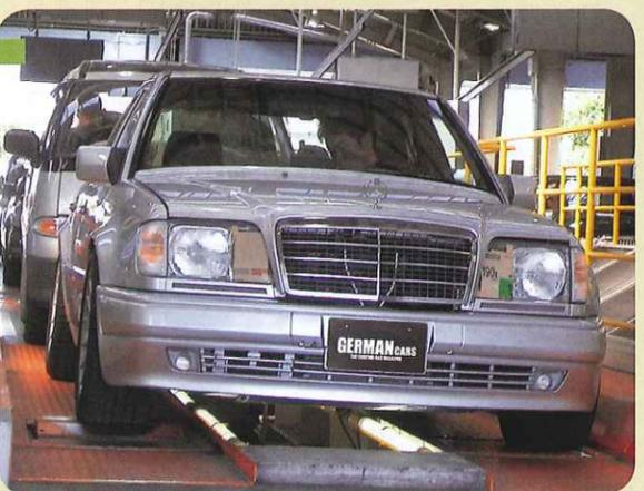
下回り検査は、排気ガス排出防止装置等のチェックのため通常の車検よりは入念に行なわれた。500Eはエアポンプ、EGR、三元触媒の装着が必要。
