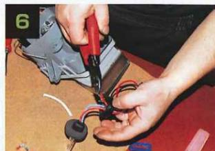
6 ブラストにいく電源線は純正配線を加工して利用することに決定。フォグ側の純正の配線を取り出し、車両側コネクタからブラストユニットにいく配線を作ることにした。
