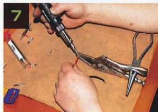
7 ブラストへの電源線を作る。黒黄色の防水コネクタはブラスト側、黒2ピンのコネクタは車両側配線へ。Sファクトでは、純正ピンを車庫に置いて配線端子加工しているから安心だ。
