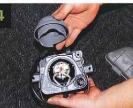
4 500Eのフォグは、防水性の高い手の込んだ裏蓋と中蓋の2重構造。丸い形状の中蓋を外せば、H1バルブと配線にアクセスできる。
