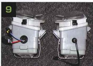
9 左がHIDパーナーと配線を組み込んだフォグランプ。右側が加工前のもの。つまり、ブラストへの電源配線は純正配線をそのまま使い、高圧配線を新たに引き直してある。
