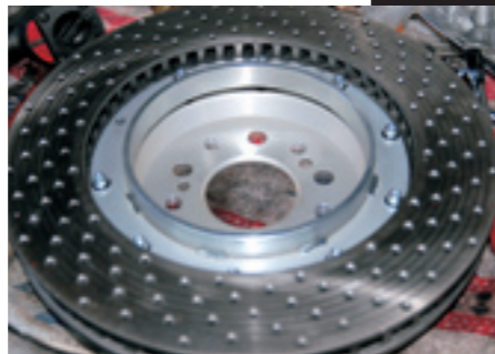
ベントンのリアローターの中にはサイドブレーキが入るため、特製のスチールドラムをセットする必要がある。
