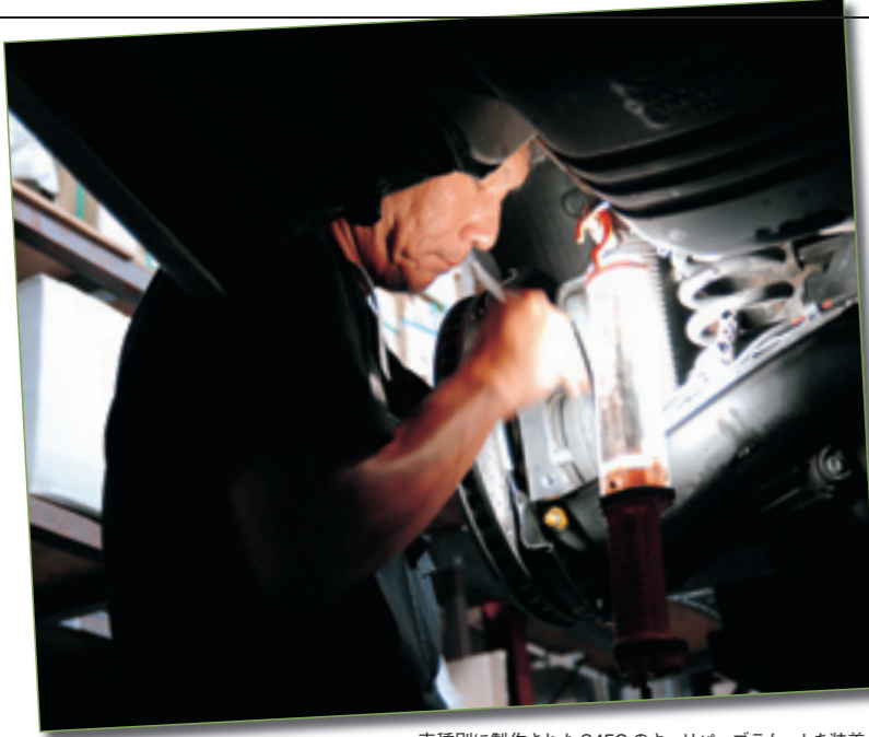
車種別に製作された S45C のキャリパーブラケットを装着。高張力キャップボルトにロックタイトで固定する。
