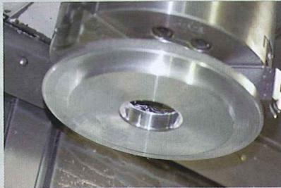
A2017 素材を旋盤で指定の寸法に加工し、車種別に製作。無粋なスペーサーを使用しないオフセット調整もOK。
