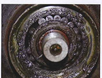
ころ軸が破損し、金属粉となったハブベアリング。数本分の隙間とグリスの色、焼きついたアウトナーに注目。
