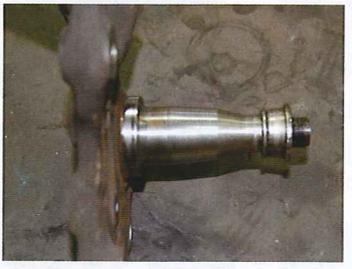
スピンドルが焼きついて再使用できない状態。ホイールのオフセットを換えると外側の細い部分に荷重がかかる。
