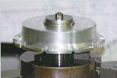
写真は他車用のベル。オフセットがプラス方向で高さがあるのがよく分かる。ツライチはスペーサーレスが常識。
