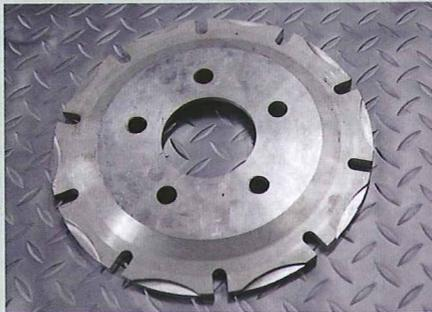
重量がかさばる大径ローターを少しでも軽くするために、摺動部以外の中央部をジュラルミンで製作し軽量化を実現。
