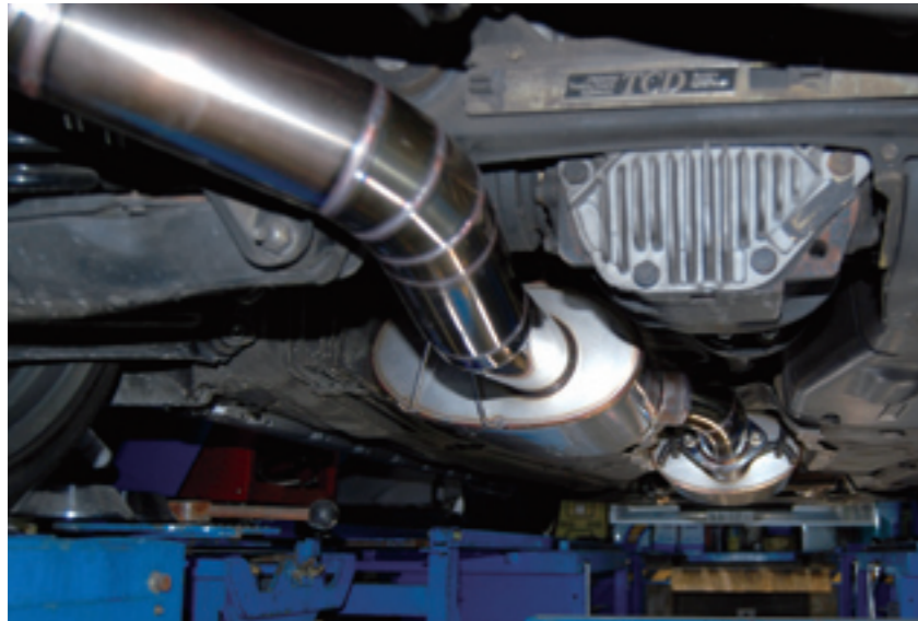
排気温度や圧力はターレにいくに従って下がるからメガン形状に広げていくのが理想。場当たり的なワンオフではなく流体力学と音響理論に従った仕様だ。
