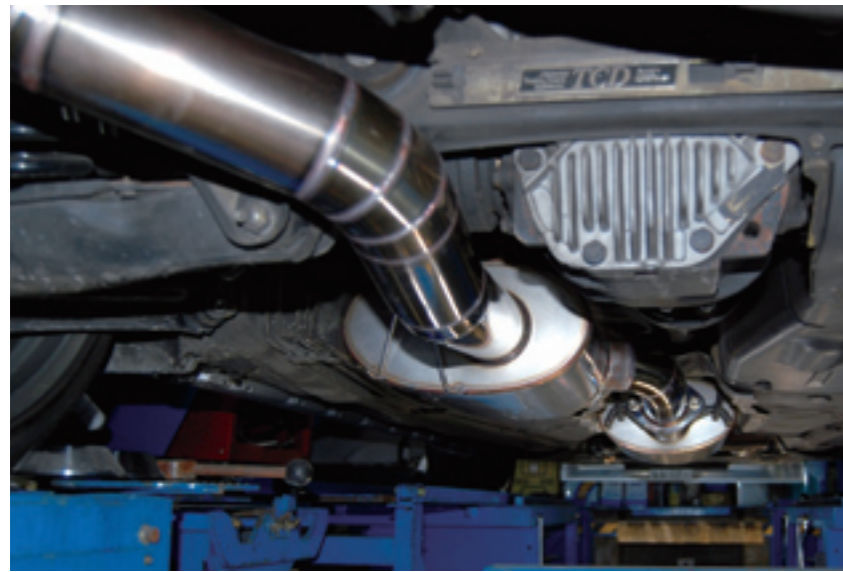
排気温度や圧力はタールにいくに従って下がるからメガホン形状に広げていくのが理想。場当たり 的ファンオフではなく流体力学と音響理論に従った仕様だ。
