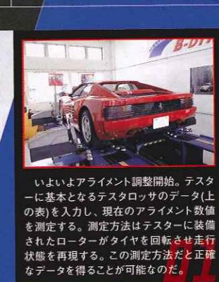
いよいよアライメント調整開始。テスターに基本となるテスタロッサのデータ(上の表)を入力し、現在のアライメント数値を測定する。測定方法はテスターに装備されたローターがタイヤを回転させ走行状態を再現する。この測定方法だと正確なデータを得ることが可能なのだ。
