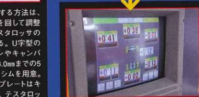
通常、アライメントを調整する方法は、アームのロッドやタイロッドを回して調整する車種が主流。だが、テスタロッサの場合にはシムを使って調整する。U字型のスチール製の平板がトーンやキャンバーを調整するシム。1.0mm~3.0mmまでの5種類と、3.25mmの計6種類のシムを用意。左右に丸穴が開いた長いブレードはキャスター角の調整用のシム。テスタロッサのアライメント調整を行う時は必ず用意しなくていいわけがないバーツだ。もしショップにアライメント調整の作業をお願いする時は事前に確認して予約すること。アライメントを扱っているショップには、テスタ用のシムの在庫は無いので注意が必要だ。
