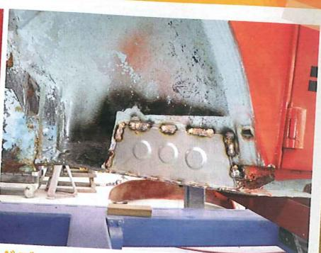
**ボディの腐りが発生していた部分は鉄板で溶接して蓋してひと安心**
