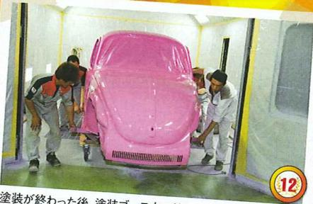
塗装が終わった後、塗装ブース内で熱を加えて塗料を硬化させる。実際に塗装が完全に硬化するまではまだ時間がかかるのだが、撮影の都合もあるので大体硬化したところでブースから外に出すことになった。さて、どんな感じに塗り上がったかな? ちなみに、フェンダー類に関してはひと足先に完成していた。
