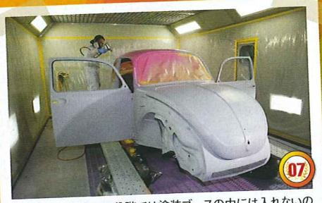
塗装開始。本来この段階では塗装ブースの中には入れないのだが、今回は撮影のために短時間だけ中に入れていただいた。このブースの隣には、ほぼ同じくらいのボリュームがある巨大な換気装置が置かれていた。巨大な掃除機の上で作業をしているようなものなので、塗料の飛沫が飛んでくるということはない。
