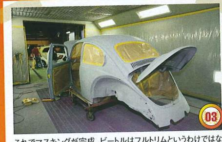
これでマスキングが完成。ビートルはフルトリムというわけではないので、インテリアに関しても鉄板が露出している部分は全て塗装する。前回、オレンジ色に塗ったときは本当に表面だけをサッと塗ってもらったので、この写真のようにドアの開閉面にはまだオリジナルのボディカラーだった水色が残っている。
