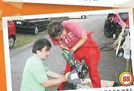
幅は大体合わせることができたので、次は前後長を合わせるという作業。しかし、この6Nボロのダッシュを、1303のウインドウに合わせてカットするのは結構面倒な作業。本当にカーブに合わせてカットするには結構面倒な作業。何度も位置や形状を合わせながら少しづつ切るのだが…。
