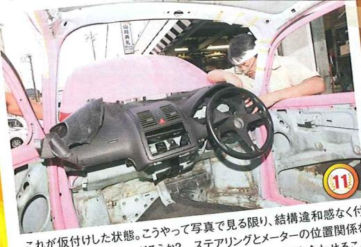
これが仮付けした状態。こうやって写真で見る限り、結構違和感なく付いているようにみえないだろうか？ステアリングヒーターの位置関係を考慮した結果、実際にダッシュの左側だけを切って幅を合わせることになった。左側に見えるゴチャゴチャしたのはダッシュの表面から剥がしにビニールのカバー。これを巻き込んで止めれば仕上げもきれい。
