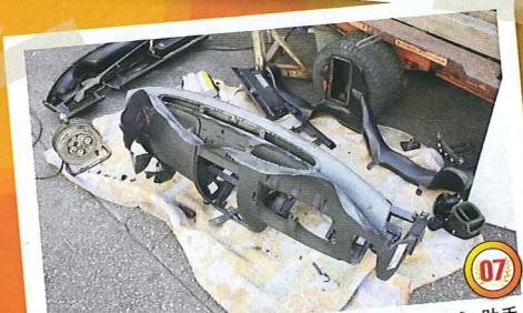
もちろんダッシュボードの裏にはスイッチやハーネスから、助手席エアバッグまで、様々なパーツが組み込まれているので、作業の前に全部外しておかなければならない。表面をカバーしているビニールの部分は、装着するときに内側に巻き込んできれいに仕上げるため、事前にめくって剥がしておく。
