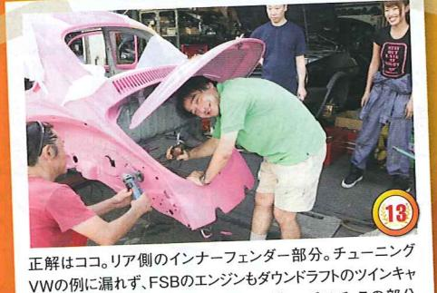
正解はココ。リア側のインナーフェンダー部分。チューニングVWの例に漏れず、FSBのエンジンもダウンラフトのツインキャブなので、キャブ調整が無茶苦茶やり難い。そこで、この部分にサービスハッチを開けてしまおうというのだ。今ならまだエンジンが載っていないので作業も簡単。
