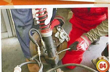
ビンギーでは操舵系をウォーム&ローラーから75年モデル以降に使用していたラック&ピニオンに変更するため、ハブキャリアも交換します。現在はトップラインのサスケットを使用中ですが、これはノーマル幅のフェンダーで17インチのホイールを装着するための苦肉の策として装着した物。
