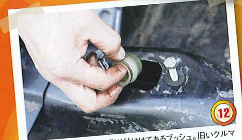
これはシフトロッドの所に取り付けたあるブッシュ。古いクルマの場合、このバーチが脱落してしまっている例が多く、「ビートルのシフトレバーはグラグラ」と誤解される原因になっています。交換するためには、前述のようにシフトロッドを前方から抜き取る必要があるのでちょっと面倒です。
