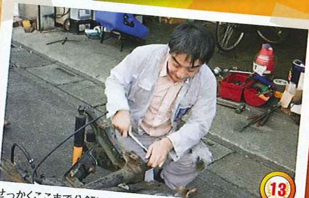
せっかくここまで分解してしまったので、リアサスペンション周りのブッシュ類も全交換してしまうことにしました。私が外しているのは、トーションバーのキャップ。この筒の中に横置きでトーションバーが入っていて、スプリングプレートを挟む形で2個のブッシュが組み込まれているのです。
