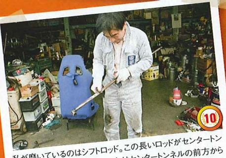
私が磨いているのはシフトロッド。この長いロッドがセンタートーンネルの中を貫通しています。これはセンタートーンネルの前方からネルの奥まで走っています。VWビートルの前にはそれを抜き出すという構造になっています。しかし、シャンのみだと面倒のための小窓が設けられています。シャンの外側を削ることで、センタートーンネルの奥までシフトロッドを出しやすくなります。
