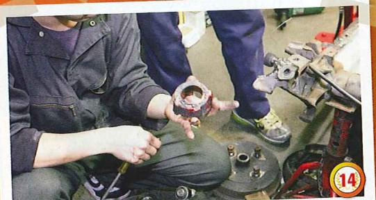
本来は黒いラバー製ですが、ビンギーの場合はすでにナイロンの強化型に交換されています。トーションバー自体もノーマルより太い強化型に交換すると、換算できます。ブッシュ類をナイロンやテフロンなどの強化型に交換することで、音や振動が減ります。しかし、“草レース用”というこのクルマの用途を考えると、その程度は許容範囲内でしょう。
