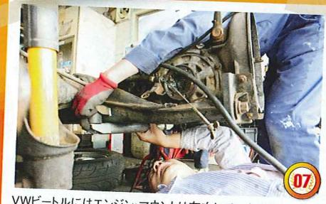
VWビートルにはエンジン・マウントは存在しません。エンジンはミッションに取り付けられて、ある意味“宙に浮いた”状態となっています。ミッションを取り外すには、まずシフトロッドとミッションを分離し、クルマの下に潜ってフロント側のマウントを固定するボルトを緩めます。
