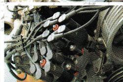
タペットカバーからのオイル漏れも止まり、クラッチカバーも交換されて気分も一新ですが、載せたらもう見えない(笑)。クラッチからの異音はシャフトからではなくフォークの爪とベアリングの間から出ていたようです。
