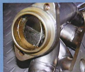
気筒間の排気干渉を防止するためのディバイダー。合流角度によっては円形になる「十二夜」形状の仕切り板がポイントとなっている。
