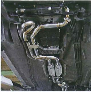
純正マニ最強の「サクラム管」。トログ形状で左右フロントパイプを等長化する。
