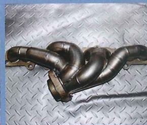
1-4番、2-3番の排気脈動と、1-2番の吸排気干渉防止セオリーによる非等長「等圧管」。高熱の排気温に備えてWPC処理が施され、鈍く光る。
