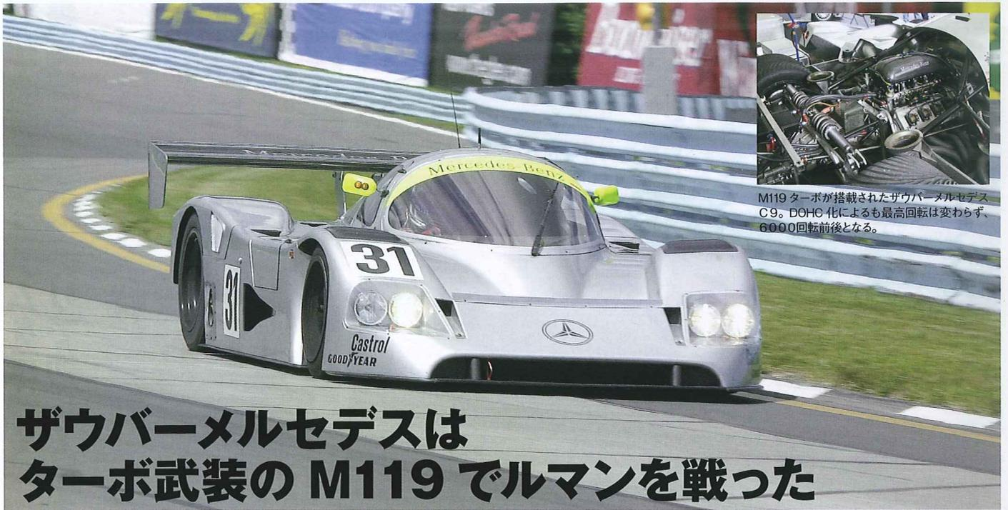
M119ターボが搭載されたザウバーメルセデスC9。DOHC化によるも最高回転は変わらず、6000回転前後となる。
