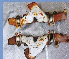
走行不明のM119 エンジンから取り外したイモ足。時間距離が多いか、水温が上がって遅角によるもので、排気干渉による焼けが大きくっている。
