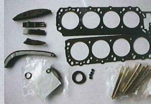
レールと同時に交換した部品は、水漏れ対策のヘッドガスケット。角度締方式のヘッドボルトの再使用はできない。
