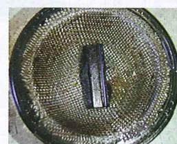
ストレーナーの網の部分にはレールの破片が吸い付いていた。これで油圧が下がるとエンジンが焼き付く。
