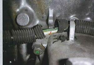
ボスケーブルはご覧の通り。被服の劣化と破損でショート寸前の状態。車両火災を招く重大トラブルに繋がる要注意ポイント。
