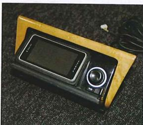
ダッシュ内部にレーダー表示部のインストールが完了し、扉をフリップダウンした状態。シガーライターも使用可能。
