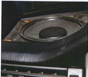
ドアマウントスピーカーに変更し、使用しなくなったダッシュ上のスピーカーグリル内にレーダー用スピーカーを隠して設置。
