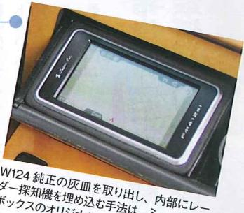
W124 純正の灰皿を取り出し、内部にレーダー探知機を埋め込む手法は、ミュージックボックスのオリジナル。
