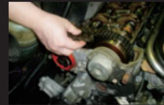
STEP-01にプラスして、ヘッドカバーを開けるだけで交換できるアッパーのガイドレールを交換する定番メニュー。
