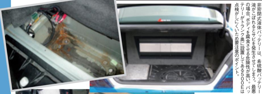
非密閉式液体バッテリーは、希硫酸バッテリーがこぼれるとサビを発生させてしまう。最悪の場合、ボディを腐食させる危険性が高い。バッテリーがトランク奥に設置してある500Eは点検がしにくい。ため注意のポイントを。
