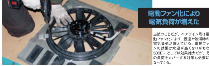
当然のことだが、ヘアライン号は電動ファン化により、低速や渋滞時の電気負荷が増えている。電動ファンの効果は水温が高くなりがちな500Eにとっては効果絶大だが、その負荷をカバーする対策も必要になってくる。
