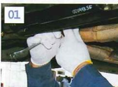
脱着作業は、アンダーカバーとフロントパイプ、クロスバー等を外して、狭いエンジンルームの下側からミリ単位で工具を動かしてやつてギアボックスを外す。
