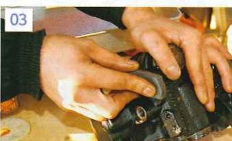
組み付け後のオイル漏れの原因となる、要注意部分である。パワステホースのフランジの当たり面をオイルストーンで修正。組み付け時に細心の注意が必要。
