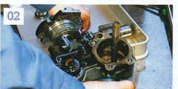
取り外した後に手際良く分解されるステアリングギアボックス。インプットシャフトを引き抜く……。
