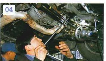
逆の順番でテキバキと組み付ける。最大の難関は前面のパワステホースの固定ボルト。傷付けないように慎重に作業を行いましょう。
