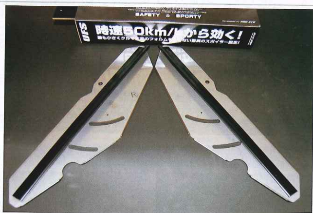
ブレードの取り付け角度が調整式であるため、セッティングの自由度が高いのも嬉しい。硬質ゴム仕様のためもちろん車検対応。
