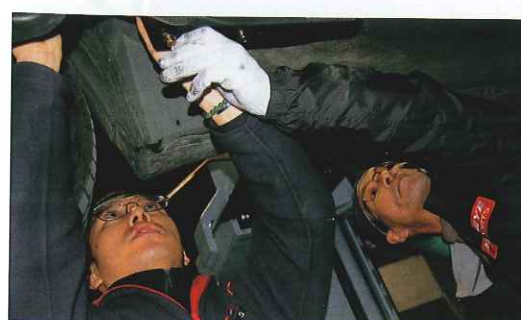
ボディに加工することなく、ボルトとナットだけで取り付けられるように車種別専用設計をしていることから、取り付けは左右でほんの15分程度。
