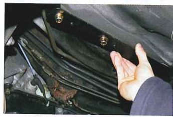
ステーを利用してボルトオンで無加工で取り付けられる。ダウンフォースによりショックの伸縮が強化されたようなフィールとなる。
