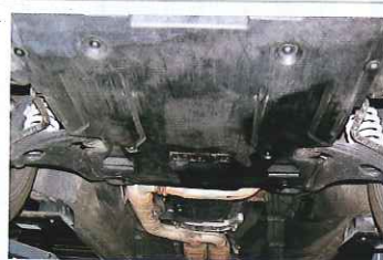
ブレードの取り付け角度が調整式であるため、セッティングの自由度が高いのも嬉しい。硬質ゴム仕様のためもちろん車検対応。
