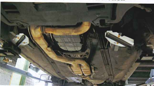
ステーを利用してボルトオンで無加工で取り付けられる。ダウンフォースによりショックの伸縮が強化されたようなフィールとなる。
