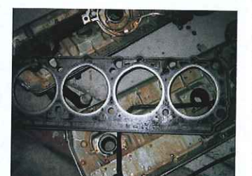
触媒の詰まりを放置したためガスケットが抜けてしまった M119 エンジン。変形した形状に注目。
