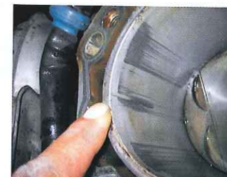
シリンダーも割れてしまった悲惨な例。こうなるとビルト載せ替えて250万円以上の出費。
