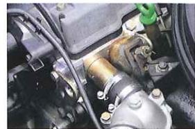
サーモスタッフとエンジンプロテクターを繋ぐ、バイパスピース＆ホースも新品に交換。バイパスピース側も古くなると水漏れを起こす。
