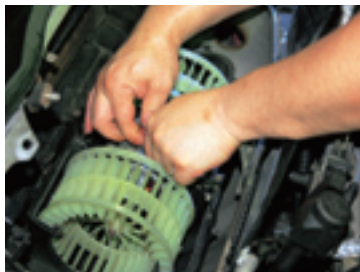
一旦組んだブローファンを取り外して新品のオートエアコン用パワートランジスタを装着する。
