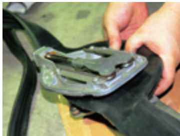
ブローファン交換のためにはワイパーを外す必要がある。ワイパー部分のゴムも美観のため一緒に交換する。
