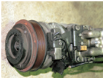
クラッチのダンパー部分が焼きついたエアコンのコンプレッサー。パワステオイルの漏れでコンプレッサーが破損することもあるとか。
