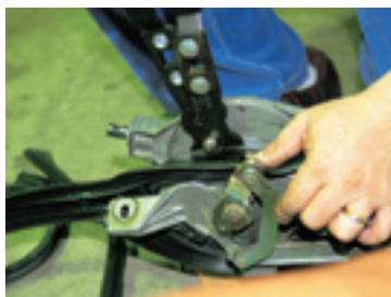
ブローファン交換のためにはワイパーを外す必要がある。ワイパー部分のゴムも美観のため一緒に交換する。
