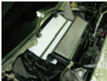
一旦組んだブローファンを取り外して新品のオートエアコン用パワートランジスタを装着する。
