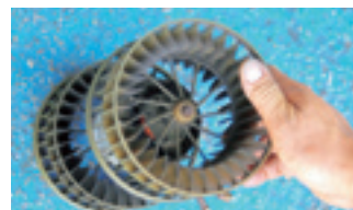
モーターの軸受け部が焼きついて壊れた旧ブローファン。13年の使用で汚れが目立つ。
