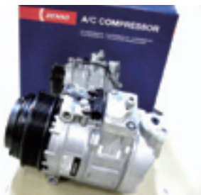
クラッチのダンパー部分が焼きついたエアコンのコンプレッサー。パワステオイルの漏れでコンプレッサーが破損することもあるとか。
