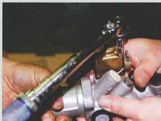
締め付けトルクは0.7kg/m。1/4のトルクレンチで作業を確実にこなす。作業中はゴミが入らないようにキャップでシールする。
