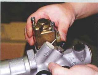
慣れた手つきで新品のマスターシリンダーにABSのユニットを組み込む。当然、Oリングは新品を使用する。
