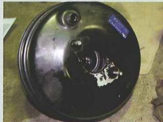
ブレーキオイル漏れでシリンダーの下側の塗料が剥がれたマスターバック。タンクの陰で見えづらい場所のため発見が困難。
