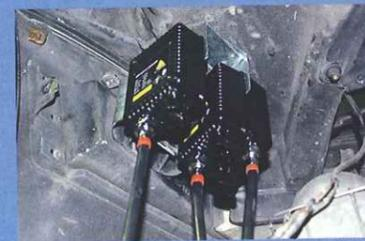
ライトを外して、裏ボタン部分に加工するハイローのH4部分と、側面に加工するH3のドライビング部分。一度にやるのがお勧め。
