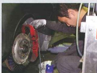
ABS装着のクルマは、エンジンをかけて、バキュームで作業しないとエア抜きが困難。8ポッドだとブリーダーも左右となる。
