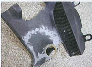
左はフットレストとサイドブレーキを逃げてマウント。振動に強い重量のある成型剤を用いて製作。
