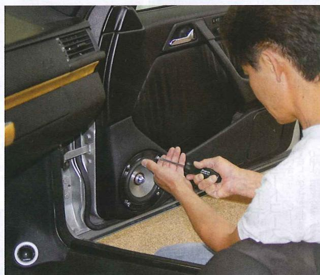
スピーカーをドアに固定するビスは、磁力に影響がない特製のノンマグネットのステンレス製。「小さな点の積み重ねがチューニング」と語る石川氏。
