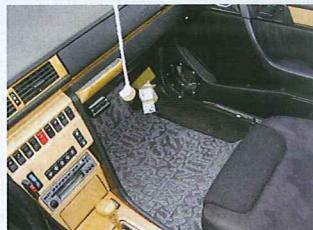
今回のポイントのツイーター設置位置を決めるためにレーザーポインターと鏡を用いて角度を測る。
